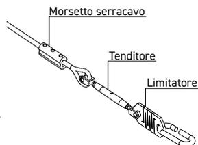
Es. di fissaggio su palo possibile installazione senza collare di cerchiaggio su altri punti fissi anticaduta tipo A
