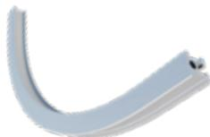
Curve per deviazioni angolari realizzate in lega di Alluminio 6063 preforati per installazione delle giunzioni. Verifica con prova in nebbia salina neutra UNI EN ISO 9227.
