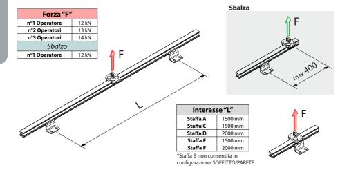
La forza sulle staffe di estremità, intermedie o d'angolo e sul relativo fissaggio strutturale deve essere valutata caso per caso in funzione della geometria del sistema e delle possibili modalità di caduta, considerando l'interasse massimo tra le campate di tutta la linea rigida TIPO D.
