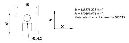
Le sollecitazioni sugli ancoranti vengono determinate dalla geometria del dispositivo, delle staffe e dell'installazione.
