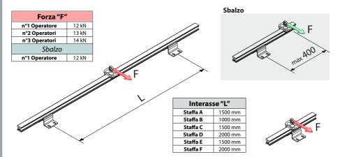
La forza sulle staffe di estremità, intermedie o d'angolo e sul relativo fissaggio strutturale deve essere valutata caso per caso in funzione della geometria del sistema e delle possibili modalità di caduta, considerando l'interasse massimo tra le campate di tutta la linea rigida TIPO D.
