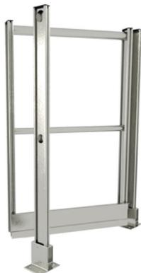
Accessorio da assemblare fornito in kit composto da cancelletto completo preassemblato e componenti di movimento e battuta da applicare in opera. Per la rotazione fornite n.3 cerniere monoblocco da fissare al montante di rotazione ed al montante del cancelletto. Sul montante opposto del cancello fissare le piastre di battuta all'altezza desiderata. La viteria necessaria è fornita nel kit di montaggio.
