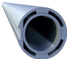
Il rinforzo interno deve presentare una lunghezza inferiore al corrente esterno di almeno 20 mm per il corretto innesto di manicotti lineari o angolari. Il bloccaggio tra i due elementi viene effettuato esclusivamente in corrispondenza di manicotti lineari ed angolari.
