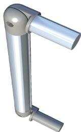
Accessorio per terminale parapetto o per moduli ribaltabili da assemblare in opera. Montaggio a cura dell'installatore come da schema. La viteria necessaria è fornita nel kit di montaggio. Attenzione al corretto inserimento dei manicotti di spessore per i correnti dotati di scanalatura. Il fissaggio delle viti nei componenti d'angolo richiede il preforo con punta di 3.5 mm.
