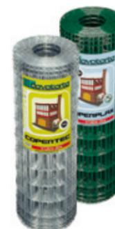
**COPERTEC:** Rete elettrosaldata con triplo vivagno alle estremità. I fili orizzontali e verticali, entrambi lineari, sono in acciaio zincato. L'impiego è finalizzato alla protezione dai rischi di caduta in fase di manutenzione delle coperture di edifici con destinazione industriale/agricola.
