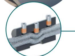
Il serraggio dei grani filettati garantisce una resistenza a trazione fino a 40kN.
