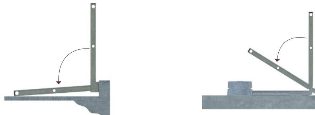
Il sistema LIMIT abbattibile è studiato e realizzato per la protezione dei bordi dove non è ammesso alcuno inquinamento visivo. Con altezza dei montanti maggiorata è necessario valutare la necessità di correnti aggiuntivi e/o della fascia fermapiède. Occorre altresì verificare assieme all'UT REGO l'eventuale variazione dell'interasse tra i montanti.
