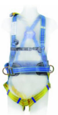
**Caratteristiche:** Imbracatura a 2 colori con 1 punto di ancoraggio dorsale e fascia di estensione + 1 punto di ancoraggio sternale + cintura di posizionamento con due anelli 'D' laterali e anelli porta-strumenti. Regolabile sulle cosce. Cinturino pettorale. Cintura pelvica.
