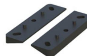
Adatto per appoggio dispositivo di ancoraggio con piastra su superfici a doppia inclinazione. I due componenti indipendenti consentono l'adattamento a molteplici pendenze [14°-22°]. Predisposto per inserimento viti, possibilità di aumentare il diametro della foratura per barre filettate.
