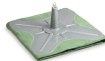
L'ancoraggio è costituito da un palo in acciaio inox con base circolare e di altezza 30 cm inserito all'interno di un cono rinforzato in fibra di vetro posto su una piastra ammortizzante e sul telo geotessile stabilizzante.
