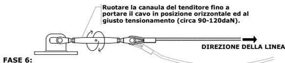
L'allineamento del cavo costituisce il punto di corretto tensionamento.
