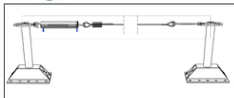
Il kit si rende necessario per il ripristino della linea flessibile Tipo C a seguito dell'entrata in funzione del sistema, previa verifica da parte del manutentore/ispettore.
