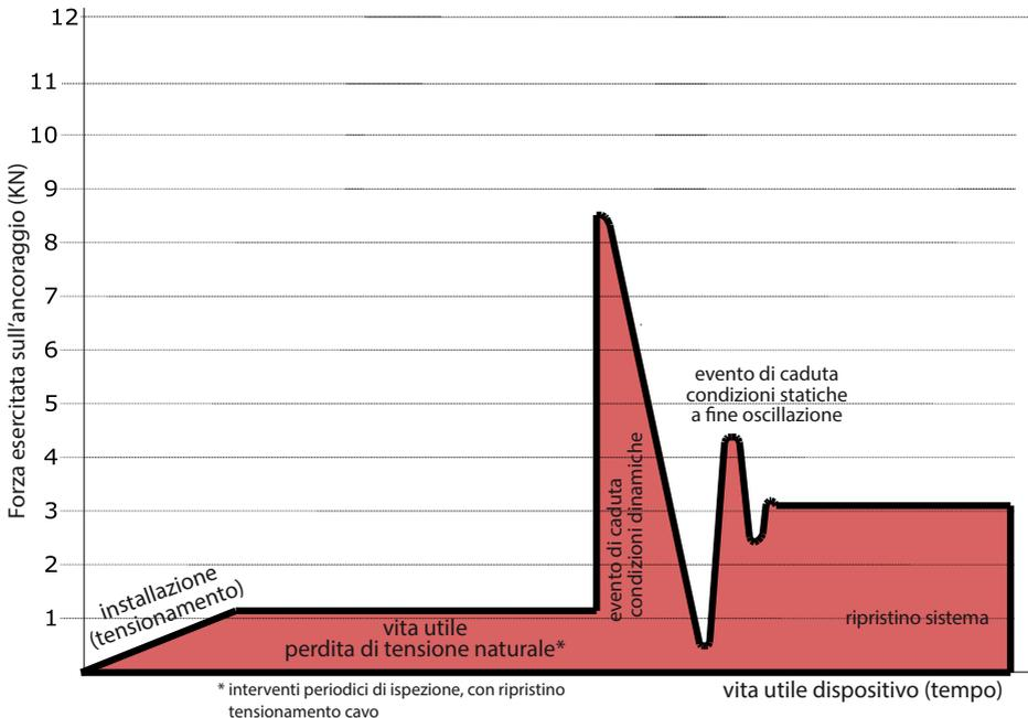
**E' OBBLIGATORIO SOSTITUIRE IL SISTEMA DI DISSIPAZIONE/ASSORBIMENTO DI ENERGIA SUCCESSIVAMENTE AD UN EVENTO DI CADUTA O NEL CASO DI RISCONTRATA DEFORMAZIONE DELLO STESSO. (VEDI CONTROLLO INDICATORE DI CADUTA)**
