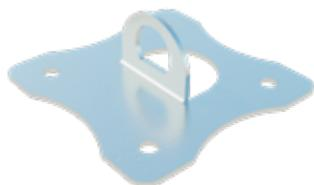
**Descrizione:** piastra in Acciaio inox AISI 304 con taglio laser, preforata e presso-piegata per la creazione di anello di aggancio per DPI anticaduta integrato nella piastra stessa. Dispositivo idoneo per operare in tutte le direzioni, fornito in kit con n.4 bulloni M8 per bullonatura su piastra estrusa in lega di alluminio della serie F-Stop CAT.
