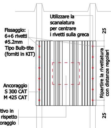
**NB. Taglia S non idonea per ancoraggi di ESTREMITÀ. Taglia M con PLATE A idonea con fissaggio su due nervature con 6+6 rivetti fino ad interasse greche 333mm.**
